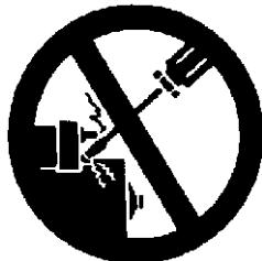
Никогда не пытайтесь завести двигатель, стоя на земле. Не пытайтесь запустить двигатель посредством короткого замыкания клемм соленоида стартера.
